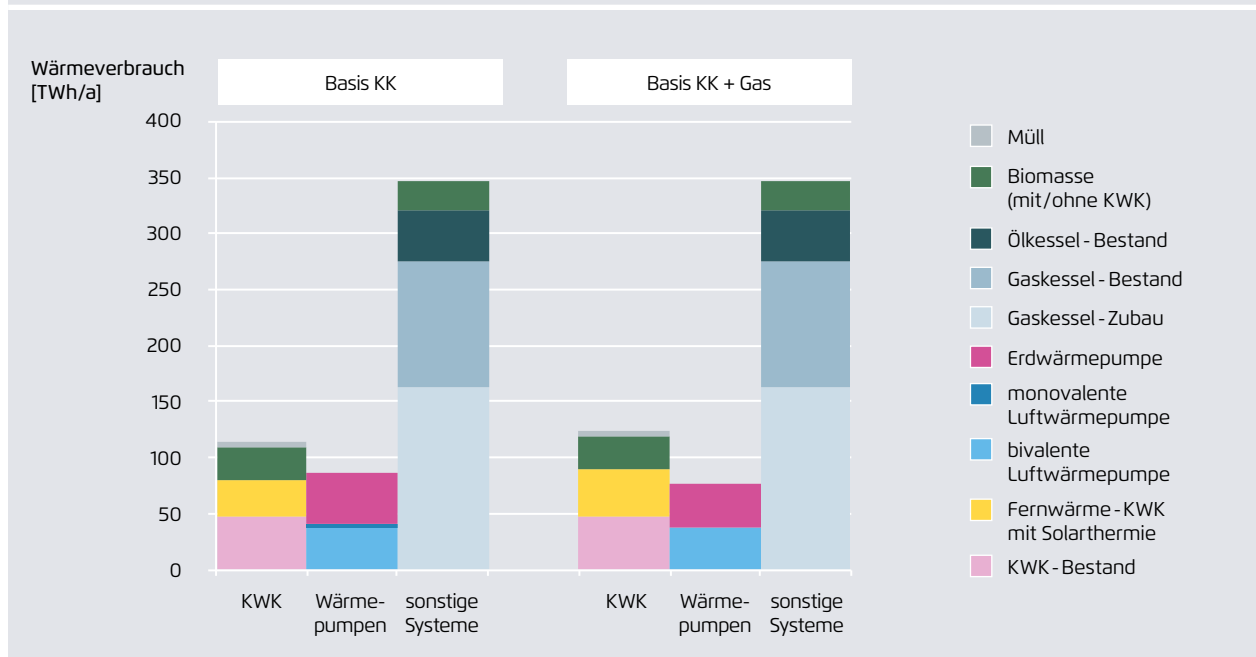
Zusammensetzung der Wärmeerzeugung in Haushalten und GHD-Gebäuden (Gewerbe, Handel, Dienstleistungen) im Basisszenario ohne und mit Brennstoffwechsel
