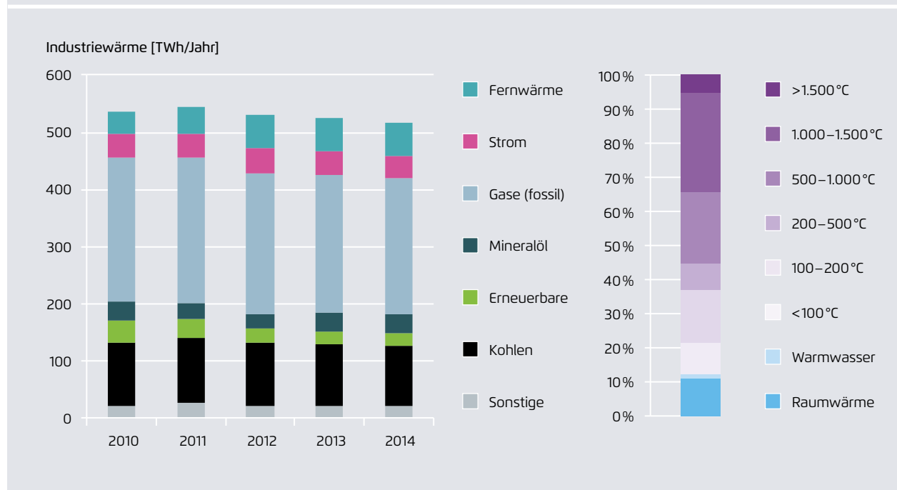
Industriegewärme-Endenergieverbrauch 2010 bis 2014 in Terawattstunden pro Jahr
