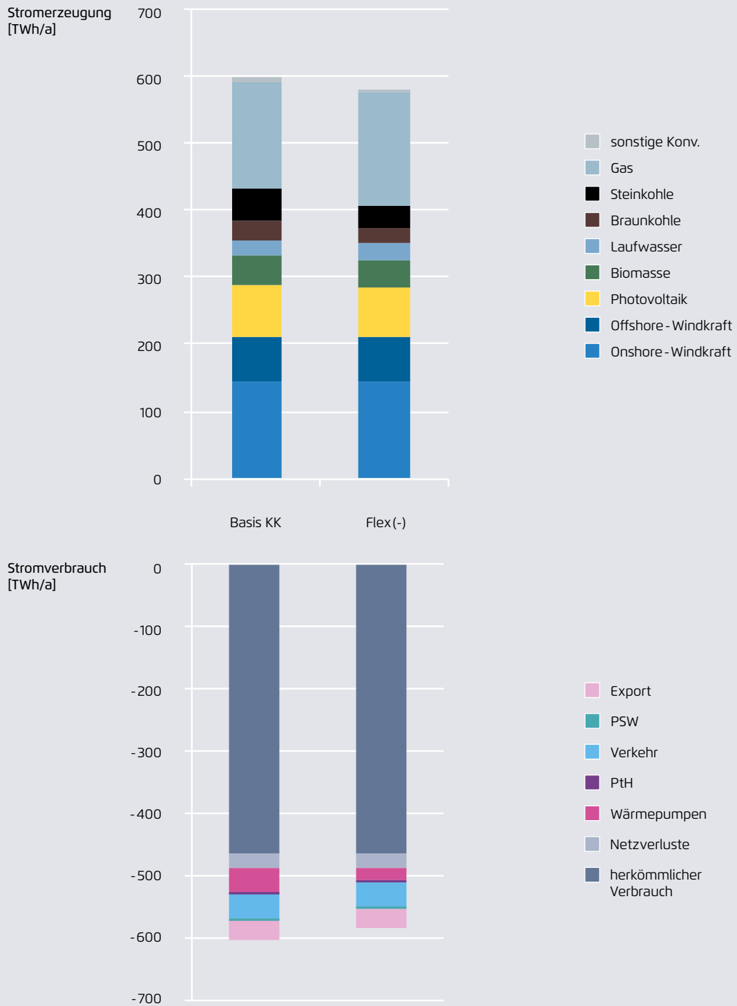
Erzeugte (oben) und verbrauchte (unten) Energiemengen in der Defizitvariante mit weniger dezentraler Flexibilität im Vergleich zum Basisszenario
