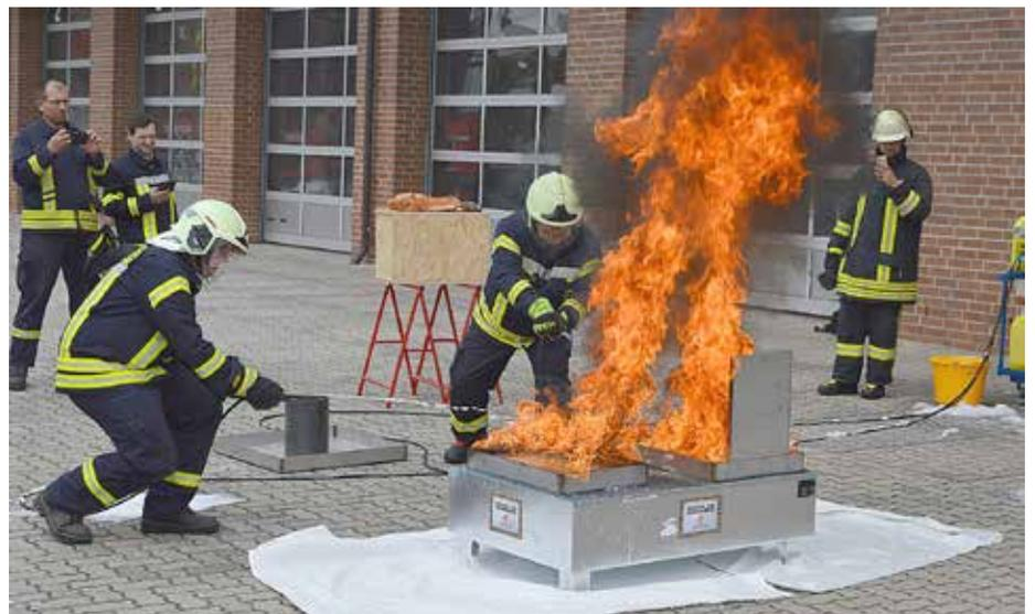
Der Schaumtrainer im Einsatz. Feuerwehr-Kameraden trainieren mit dem Gerät die Anwendung von Löschschaum und Netzmitteln.
