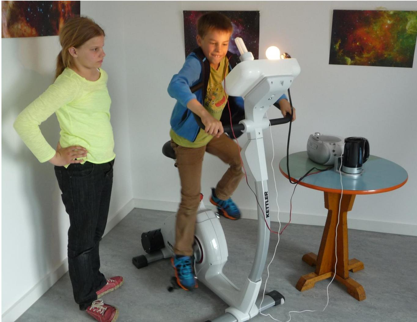
**Energiefahrrad:** Durch kontinuierliches Treten erzeugt ein elektrischer Generator (Dynamo) Strom für eine Energiesparlampe (leicht), eine 60 W-Glühlampe oder ein Radio (möglich) und einen Kochendwasserbereiter (zu schwer).
